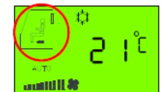
Luftklappenstellung Fuß wird angezeigt
