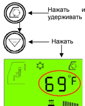
**11.11.2.9 Режим отопления при неработающем двигателе**
